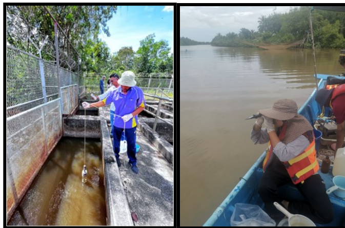
การเก็บตัวอย่างด้วยกระบอกน้ำ และการวัดค่าความเค็มของน้ำ
