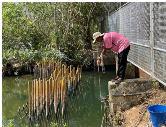
รูปที่ ง-2 : การเก็บตัวอย่างน้ำ และตรวจวัดคุณภาพน้ำในบ่อน้ำทิ้ง 1 (Holding Pond 1)
