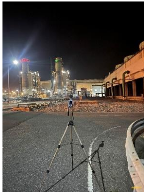
ภาพที่ 7 การตรวจวัดแสดงจุดตรวจวัดระดับเสียงเพื่อจัดทำแผนที่เส้นระดับเสียง ภายในพื้นที่โรงไฟฟ้าจะนะ จังหวัดสงขลา
